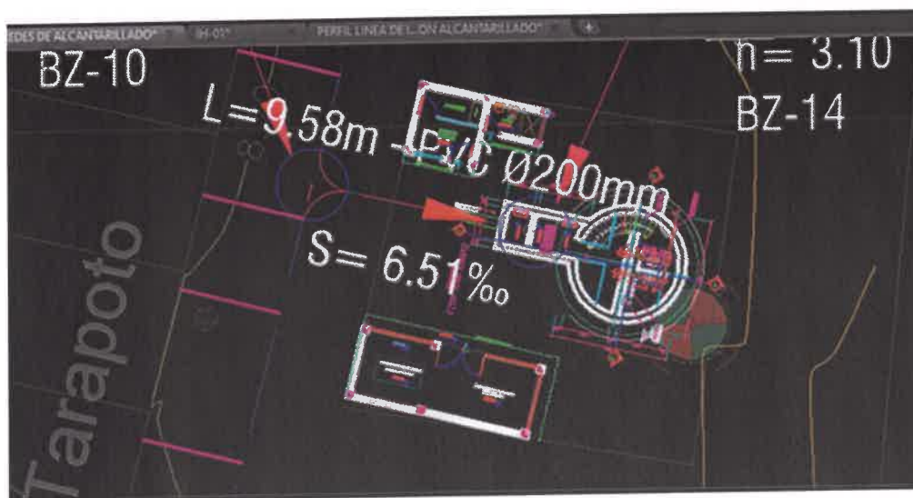
Cámara de bombeo de aguas residuales.
