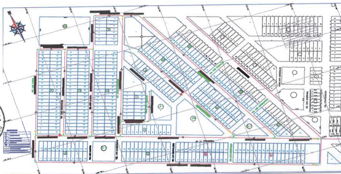
Planta redes de distribución de agua potable.
