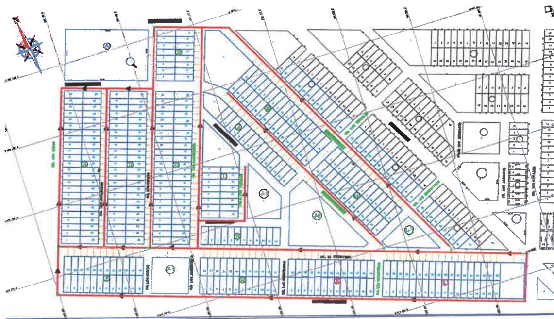
Planta de conexiones domiciliarias de agua potable.
