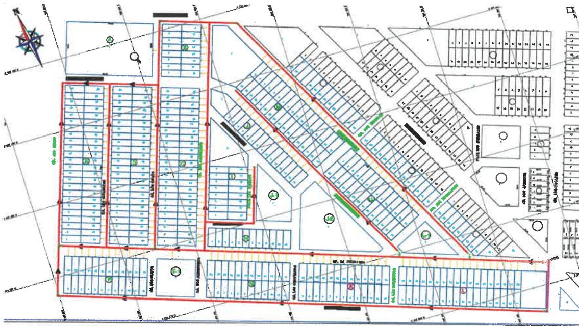
Planta de conexiones domiciliarias de agua potable.
